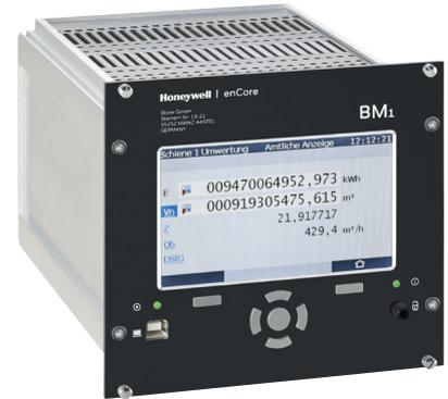
Neben den gebräuchlichen Umwertungsalgorithmen für Erdgase verfügt der enCore BM1 über Funktionen nach DVGW-Arbeitsblatt G 485 (DSfG, Digitale Schnittstelle für Gasmessgeräte). Die Datenfernübertragung verwendet TCP/IP-Netzwerk und steht mittels UMM Mobilfunk Modem auch als kabellose Variante zur Verfügung.
