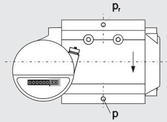
Achse Rollenzählwerk: horizontal
