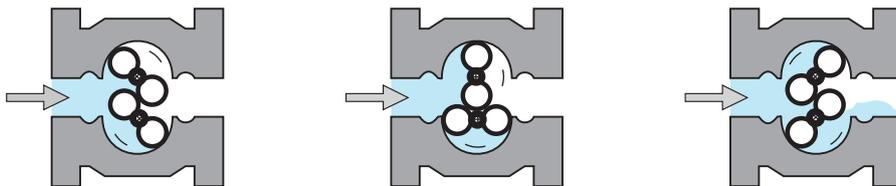
**Allgemeines:** Drehkolbengaszähler zeichnen sich durch hohen Messbereich und kompakte Bauweise aus.
